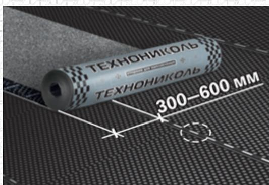
Торцевые нахлесты материалов смежных слоев не должны совпадать. Рекомендуется смещать торцевые нахлесты смежных слоев на расстояние не менее 500 мм.
