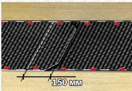
Сварите торцевой нахлест с помощью выбранного оборудования.
