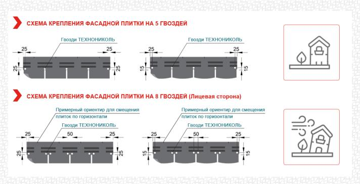
При монтаже верхнего ряда плитки гвозди одновременно крепят нижний ряд. Таким образом на каждую плитку приходится 16 (10) гвоздей.
