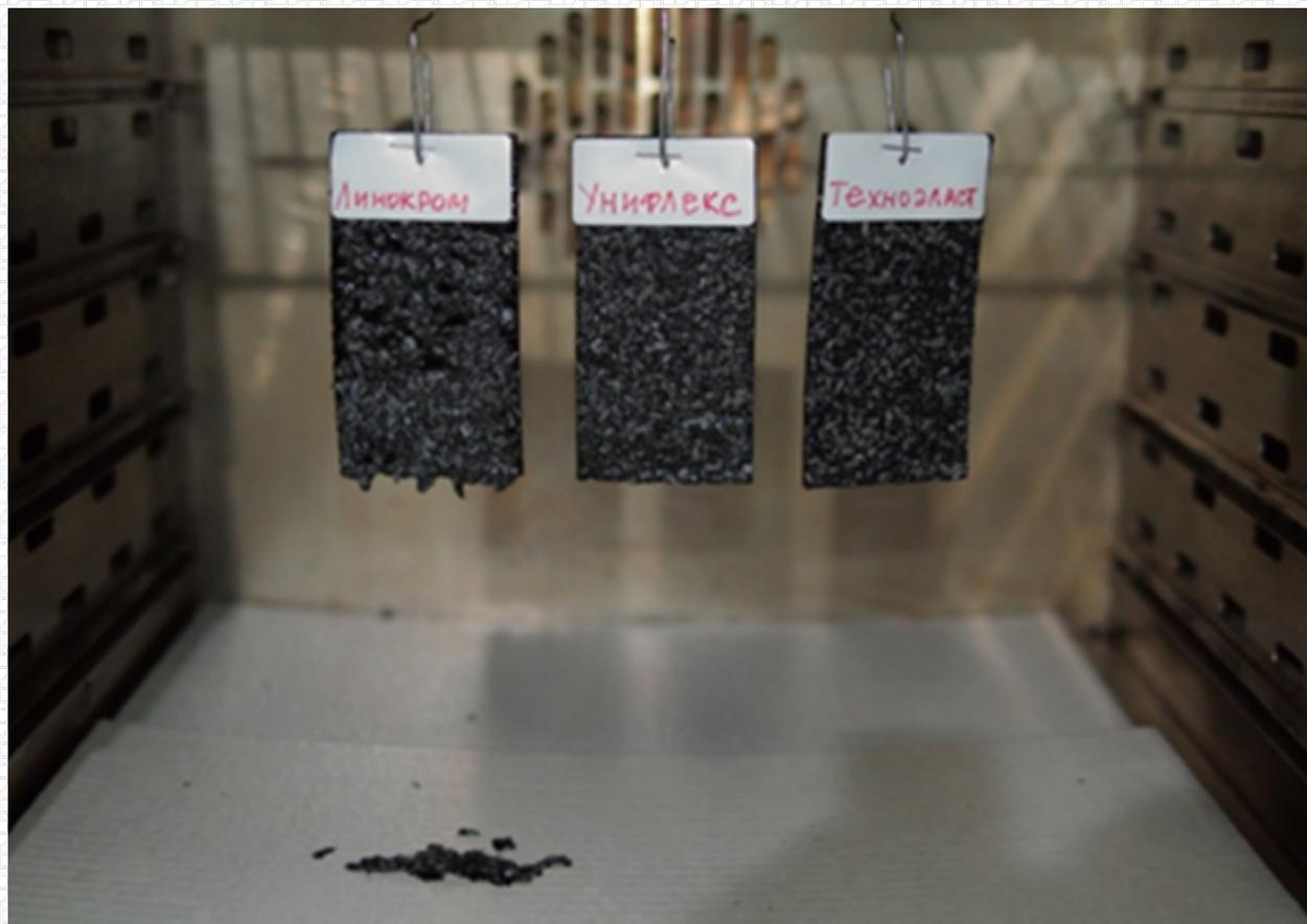
Тестирование теплостойкости материала происходит в течении 2-х часов при фиксированной температуре. За 2 часа выдержки материал не должен изменить свой внешний вид. Это вовсе не означает, что через 3 часа материал не поменяет своего внешнего вида.
