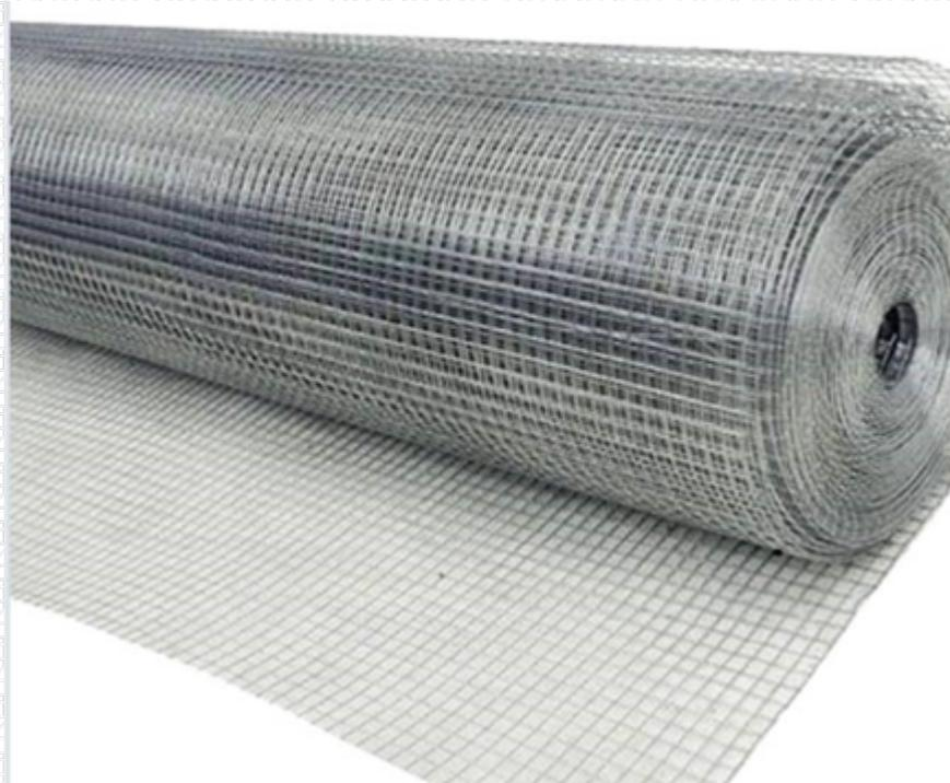
Для устройства армированного слоя в толстослойных штукатурных системах утепления, применяется стальная сетка из проволоки с защитным покрытием (оцинковка),  $D=1\text{мм}$  с размером ячейки  $19\times 19\text{ мм}$ .
