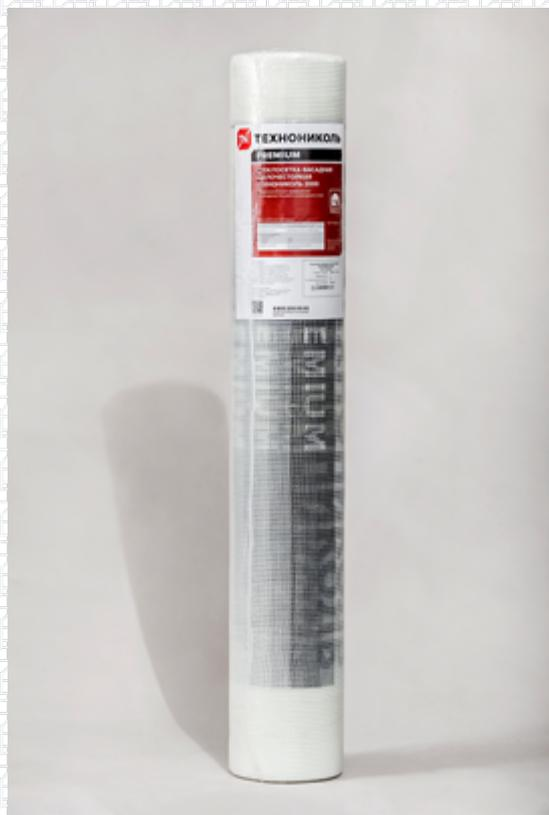
Фасадные армирующие сетки для тонкослойной штукатурки (фасадные стеклосетки) представляют собой стеклянную ткань с прямоугольными ячейками фиксированных размеров. Для придания стеклосеткам жесткости и щелочестойкости их обрабатывают полимерными пропиточными составами.
